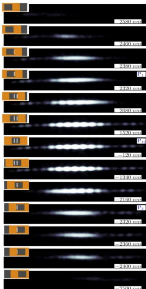
En la esquina superior izquierda se muestra la posición de una pestaña que puede controlar el número de rendijas abiertas. Se ve cómo se forma y se pierde el patrón de interferencia al pasar de una a dos rendijas abiertas y viceversa.
